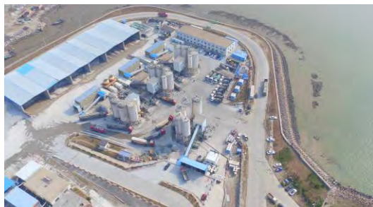
2017年无人机拍到的施工场地区（搅拌站及砂石料场）绿化及边坡防护
