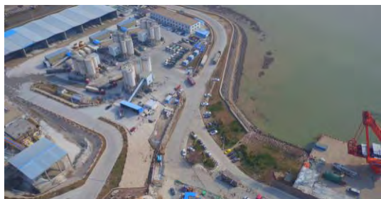
2017年无人机拍到的施工场地区（搅拌站及砂石料场）绿化及边坡防护
