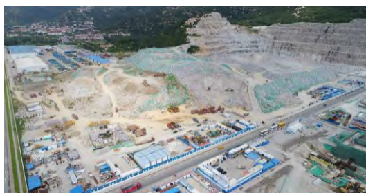
2018年3季度无人机拍到临时堆渣场密目网苫盖照片
