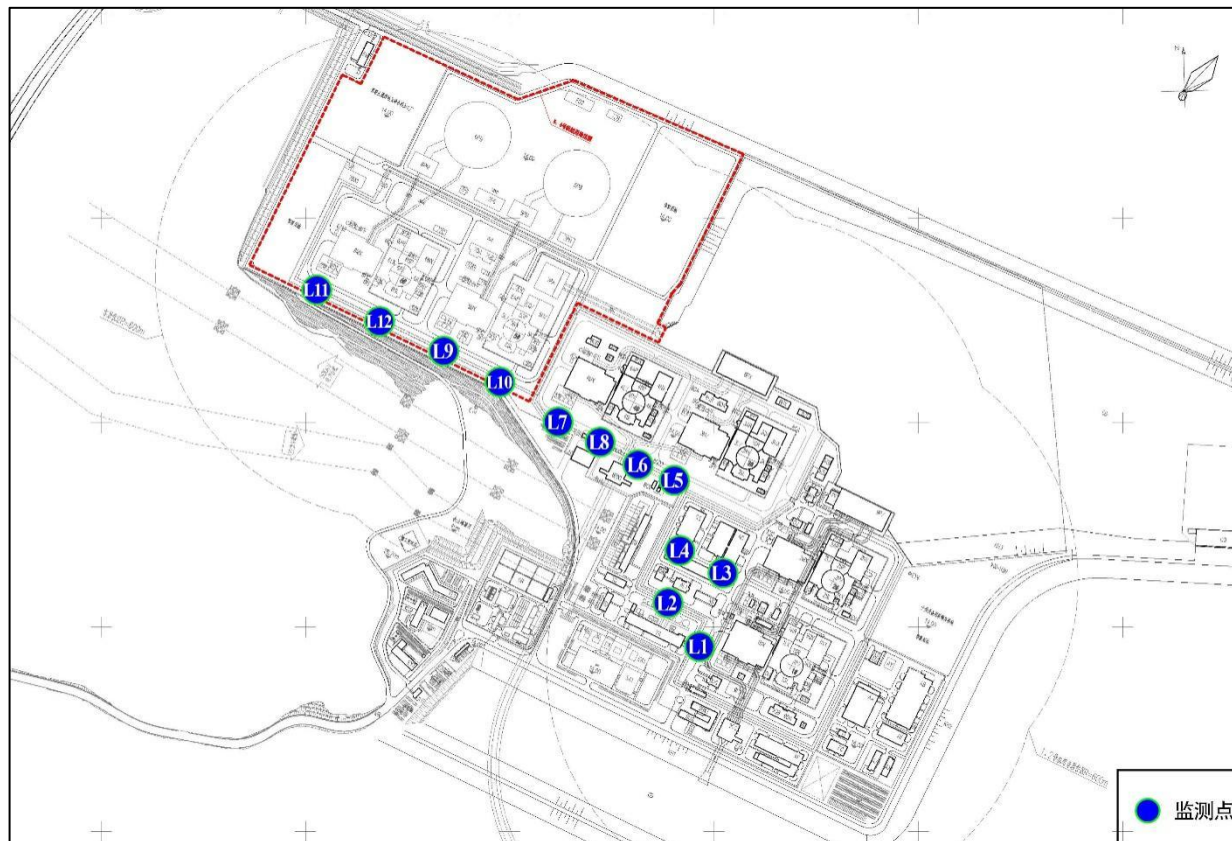
图 3.2-4 核电厂地下廊道监测点设置示意图
