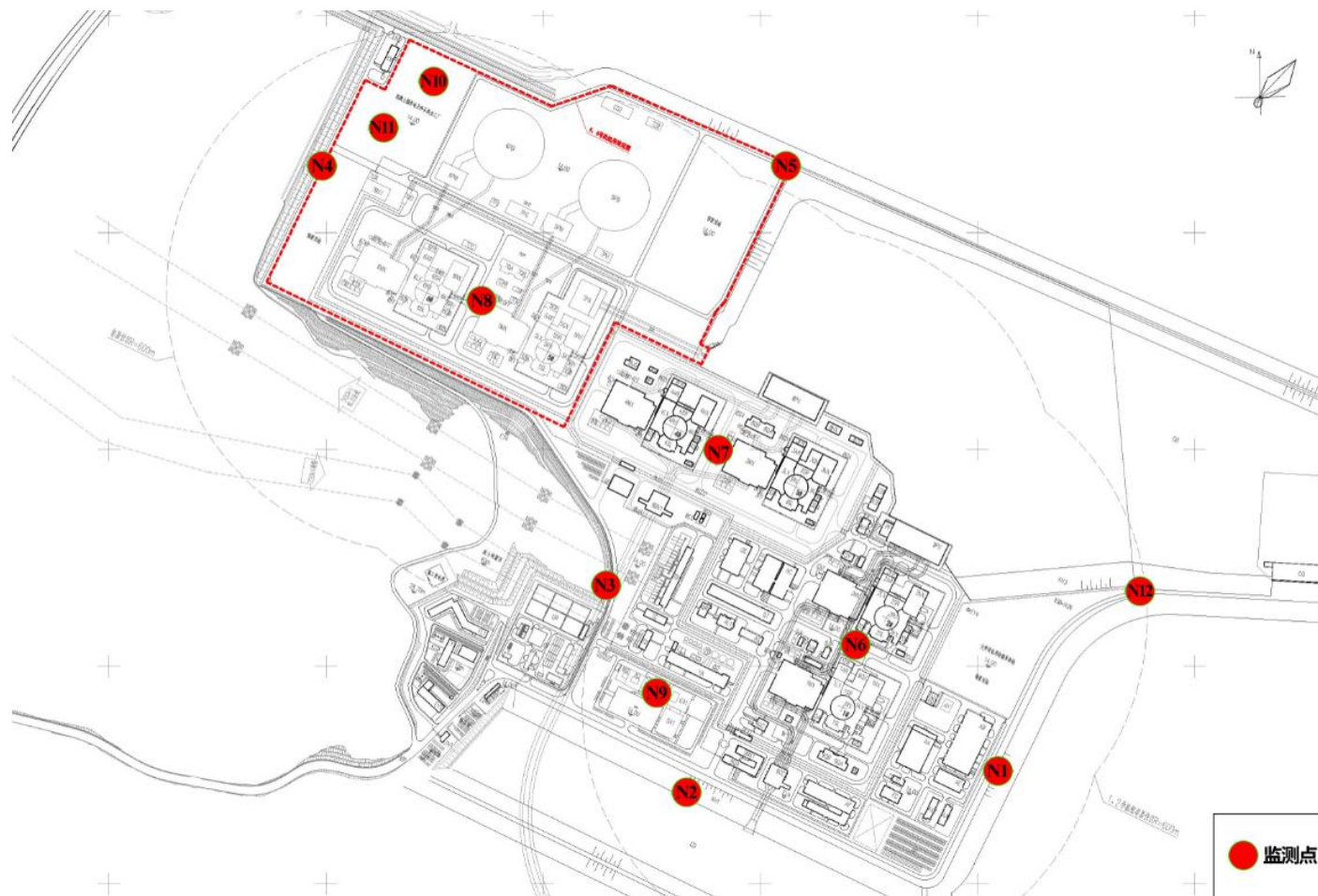
图 3.2-1 厂区内电磁辐射监测点分布情况示意图
